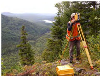
Figure 4: Levé avec un tachéomètre électronique
